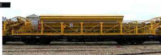
1 Au nombre de 12, les wagons granulats transportent chacun 25 m 3 d'un mélange sable-granulats.
