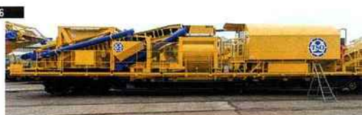
6 Le wagon malaxeur intègre le malaxeur et le poste de pilotage du train béton.
