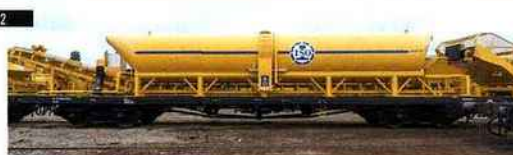
2 Le wagon citerne offre un volume de stockage en eau de 50 m 3 .
