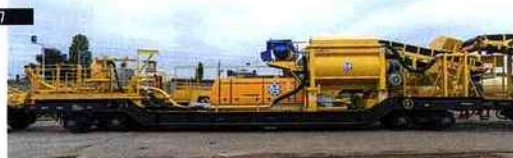
7 Sur le wagon pompe sont positionnées la pompe à béton et une trémie-tampon (qui prend la forme d'un malaxeur à doubles arbres horizontaux).
