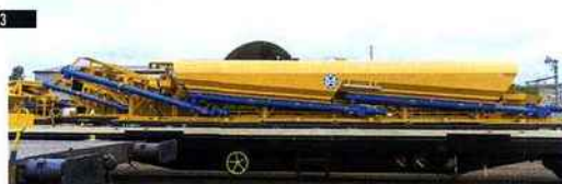
3 Le train béton compte 2 wagons ciment, d'une capacité totale de 100 t.
