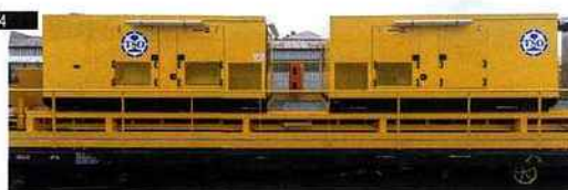
4 Deux groupes électrogènes, d'une puissance cumulée de 700 kVA, sont positionnés sur le wagon énergie.
