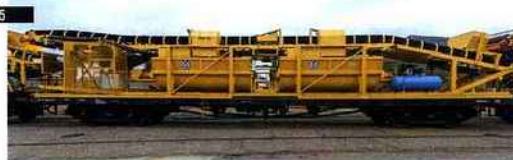
5 Le wagon souille s'articule autour de 2 trémies agitricies de 6 m 3 .
